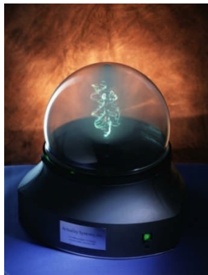
Illustration 105 Actuality Systems, Perspecta , 2002. Système d'imagerie volumétrique par projection sur écran rotatif. Le projecteur est dans la base et la vitesse de rotation est suffisamment rapide pour que l'écran disparaisse ne laissant voir que l'image.
